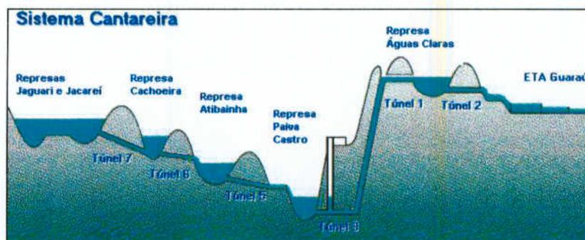
Figura 7 - Esquema Simplificado do Sistema Cantareira.
